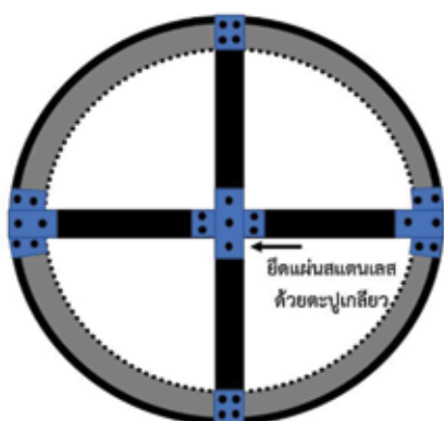
รูปที่ 5 ยึดแผ่นสแตนเลสตรงกลางวงล้อ
