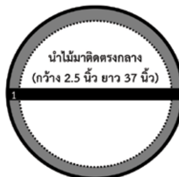
รูปที่ 3 นำไม้ขั้นที่ 1 ขนาดความกว้าง 2.5 นิ้ว ยาว 37 นิ้ว ติดตรงกลางวงกลม
