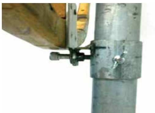
รูปที่ 9 ยึดวงล้อสวมเข้ากับแกนตั้ง
