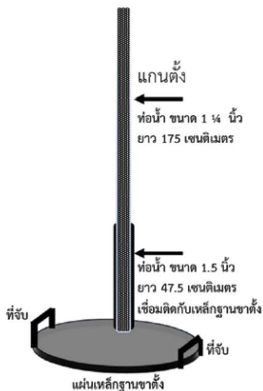
รูปที่ 8 แกนตั้ง (ท่อน้ำเหล็ก) สวมลงในขาตั้ง (ท่อน้ำที่เชื่อมติดกับฐานขาตั้ง)
