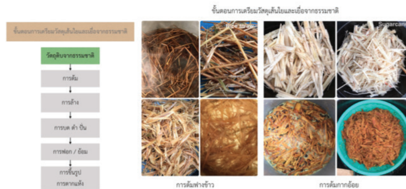
ภาพที่ ๒ ขั้นตอนการเตรียมวัสดุเส้นใยและเยื่อจากฟางข้าวและกากอ้อย
