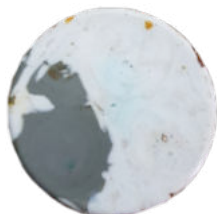
ภาพที่ 4 การทดลองอุณหภูมิความร้อนในการหลอมพลาสติกชนิด PET ที่ 270 องศาเซลเซียส ที่มา: ศุภรา อรุณศรีมรกต
