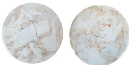
ภาพที่ 5 การทดลองอุณหภูมิความร้อนในการหลอมพลาสติกชนิด PET ที่ 280 องศาเซลเซียส ที่มา: ศุภรา อรุณศรีมรกต
