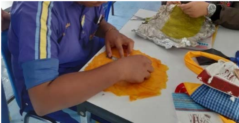
ภาพที่ 3 แสดงการทำพลาสติกชีวภาพ เพื่อขึ้นรูปเป็นถุงเพาะชำเกิน 1 ชั้น
