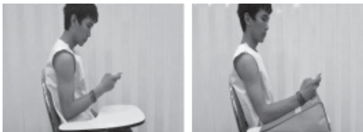
ภาพที่ 2 แสดงท่าทางการทดสอบมุมของคอในขณะที่ใช้แท่นวางแขนปรับระดับ (ก) และขณะเล่นสมาร์ทโฟนโดยไม่ใช้แท่นวางแขนปรับระดับ (ข)
