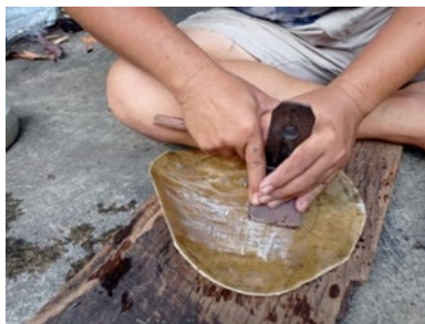
ภาพที่ 4 การไสหนังเพื่อปรับความหนาของหน้าตะโพนให้เสมอกัน ที่มา: ชนะใจ รื่นเริง
