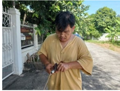
ภาพที่ 2 การควั่นไส้ละมานด้วยสว่านมือ ที่มา: ชนะใจ รื่นเริง
