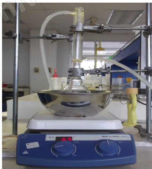
ภาพที่ 2 แสดงการติดตั้งอุปกรณ์การสังเคราะห์ไบโอดีเซลด้วยปฏิกิริยาทรานส์เอสเทอร์ริฟิเคชัน
