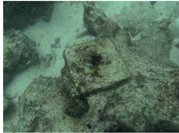
ภาพที่ 3 แผ่นกระเบื้องที่ติดตั้งในแนวปะการัง และเมื่อเวลาผ่านไป 4 เดือนหลังจากติดตั้ง
