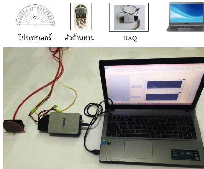
ภาพที่ 2 อุปกรณ์และระบบการวัดค่าการเคลื่อนที่เชิงมุมกับค่าความต้านทานไฟฟ้า
