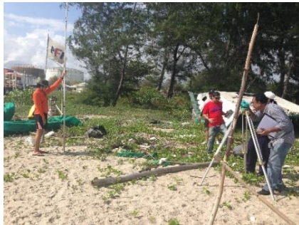
ภาพที่ 2 การศึกษาลักษณะของคลื่นและการเปลี่ยนแปลงของแนวชายหาดตำบลเขารูปช้าง จังหวัดสงขลา (A) การติดตั้งเครื่องวัดระดับน้ำและคลื่น (Solinst Level Logger Model 3001) โดยผูกติดไว้กับทุ่นเพื่อถ่วงน้ำหนักและหย่อนเครื่องมือพร้อมทุ่นที่ปลายสะพานเพื่อตรวจวัดคลื่น ในบริเวณชายฝั่งของสถาบันวิจัยการเพาะเลี้ยงสัตว์น้ำชายฝั่ง กรมประมง กระทรวงเกษตรและสหกรณ์ จังหวัดสงขลา (B) การทำ Beach Profile บริเวณชายหาดตำบลเขารูปช้าง จังหวัดสงขลา
