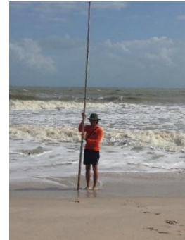
ภาพที่ 2 การศึกษาลักษณะของคลื่นและการเปลี่ยนแปลงของแนวชายหาดตำบลเขารูปช้าง จังหวัดสงขลา (A) การติดตั้งเครื่องวัดระดับน้ำและคลื่น (Solinst Level Logger Model 3001) โดยผูกติดไว้กับทุ่นเพื่อถ่วงน้ำหนักและหย่อนเครื่องมือพร้อมทุ่นที่ปลายสะพานเพื่อตรวจวัดคลื่น ในบริเวณชายฝั่งของสถาบันวิจัยการเพาะเลี้ยงสัตว์น้ำชายฝั่ง กรมประมง กระทรวงเกษตรและสหกรณ์ จังหวัดสงขลา (B) การทำ Beach Profile บริเวณชายหาดตำบลเขารูปช้าง จังหวัดสงขลา
