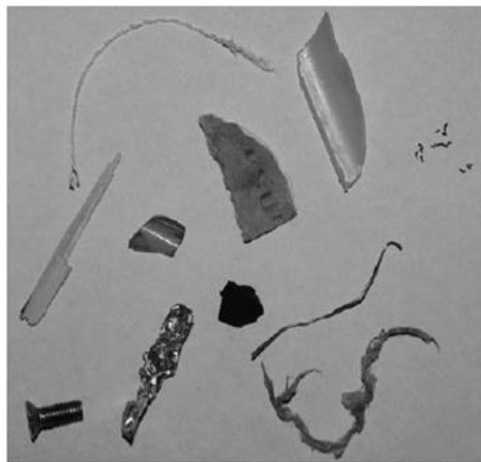
ภาพที่ 1 ตัวอย่างชนิดและลักษณะของสิ่งแปลกปลอมที่พบในโรงงานอาหาร ที่มา Beckett (2009)
