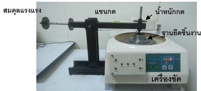
ภาพที่ 1 เครื่องทดสอบการสึกหรอแบบ pin-on-disk
