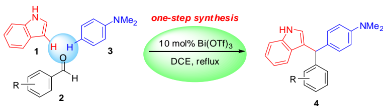
ภาพที่ 2 การสังเคราะห์สาร 3-(ไดเอซิลเมธิล)อินโดลแบบขั้นตอนเดียวของสารตั้งต้นสามองค์ประกอบ
