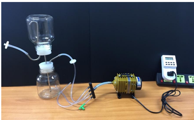
ภาพที่ 1 ระบบจุ่มแช่แบบขั้วคราว ของ Paitoon Saplee Co., Ltd
