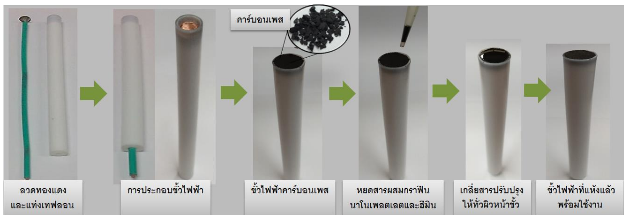
ภาพที่ 2 การประกอบขั้วไฟฟ้าคาร์บอนผสมและปรับปรุงผิวหน้าขั้วไฟฟ้าด้วยสารผสมกราฟีนนาโนฟลตเลตและอีมีน
