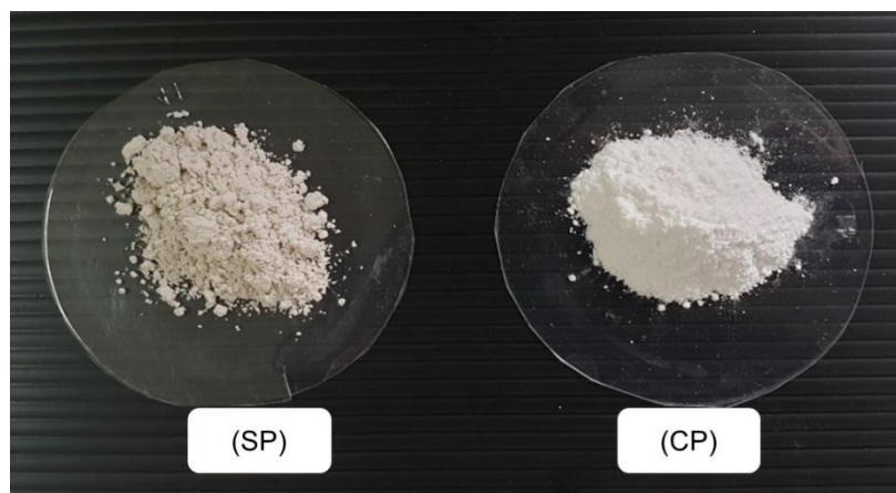
ภาพที่ 1 ลักษณะของผงเปลือกหอยมุกที่ไม่ผ่านการเผา (SP) และผงเปลือกหอยมุกที่ผ่านการเผา (CP)
