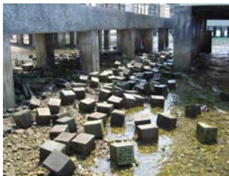
ข) ตัวอย่างคอนกรีตที่แช่ในสภาวะแวดล้อมทะเลในสภาพเปียกกลับ
