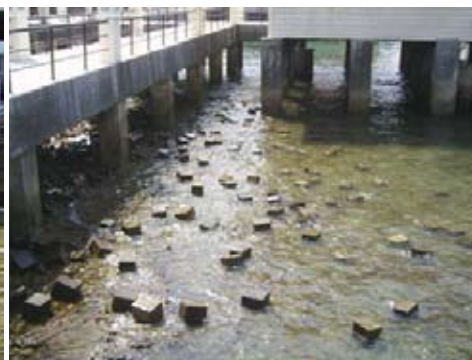
ข) ตัวอย่างคอนกรีตที่แช่ในสภาวะแวดล้อมทะเลในสภาพเปียกกลับ
