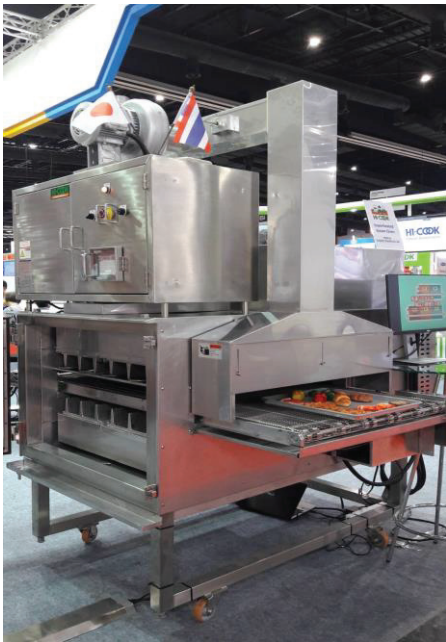
ภาพที่ 1 เครื่องทอดลมร้อนด้วยความดันจากโบลเวอร์แบบสายพานที่ผลิตในประเทศญี่ปุ่น
